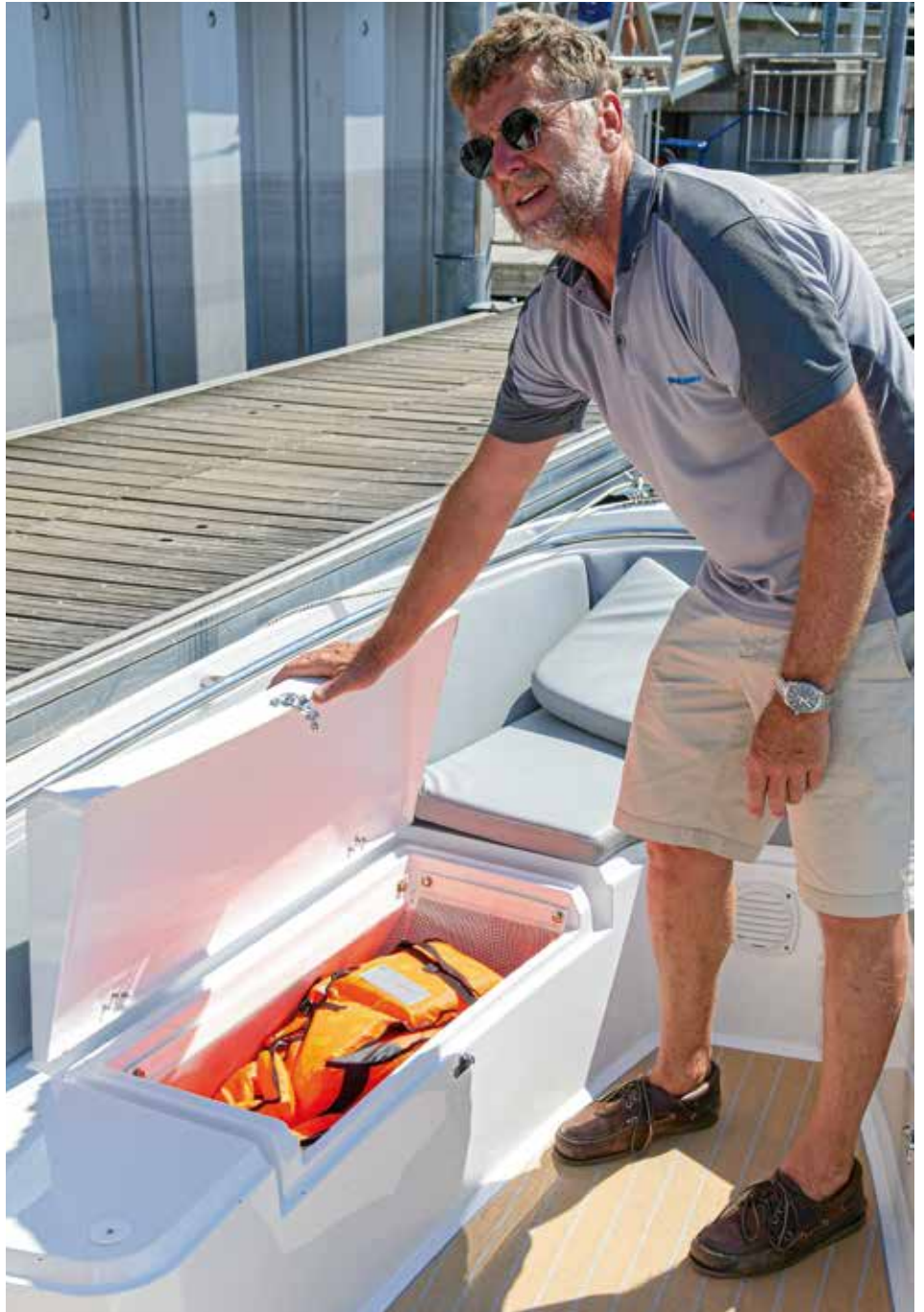
Pfiffige Idee: Der Raum zwischen Schale und Deck ist offen und dank verschiedener Öffnungen durchlüftet. Die Ausrüstung in den Backskisten liegt, ebenfalls hinterlüftet, in angeknöpften Netztaschen.
