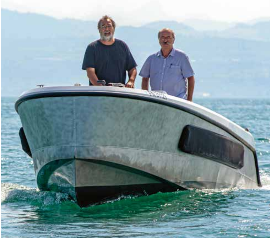
Interessante Spantform für gute Fahreigenschaften und viel Platz an Deck. Die Kissenfender sind fest montiert.
