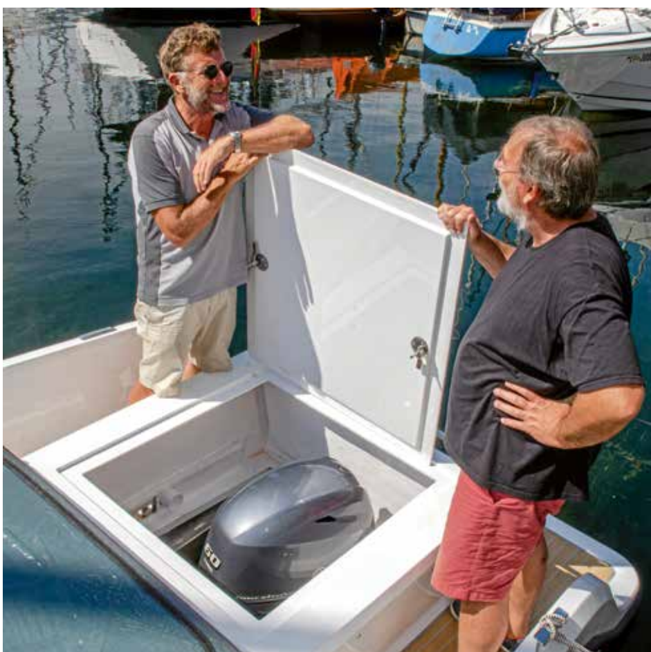
Der Motor sitzt unter einer Klappe etwas vor dem Ende der Wasserlinie. Dadurch ergäbe sich sogar noch etwas Potenzial bei der Schalldämmung des ohnehin schon recht leisen Antriebs.
