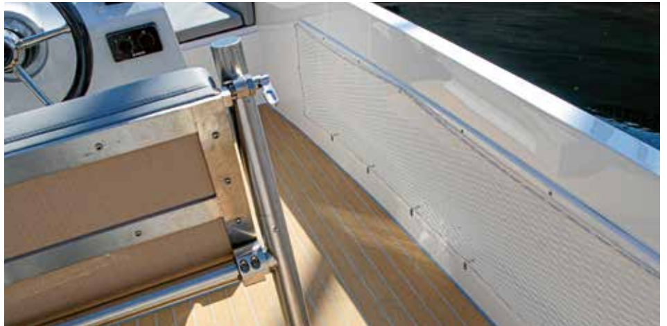
Hinter dem Netz am Schanzkleid ist Platz für Ausrüstung. Dahinter befindet sich die Verschraubung für die festen Fender.
