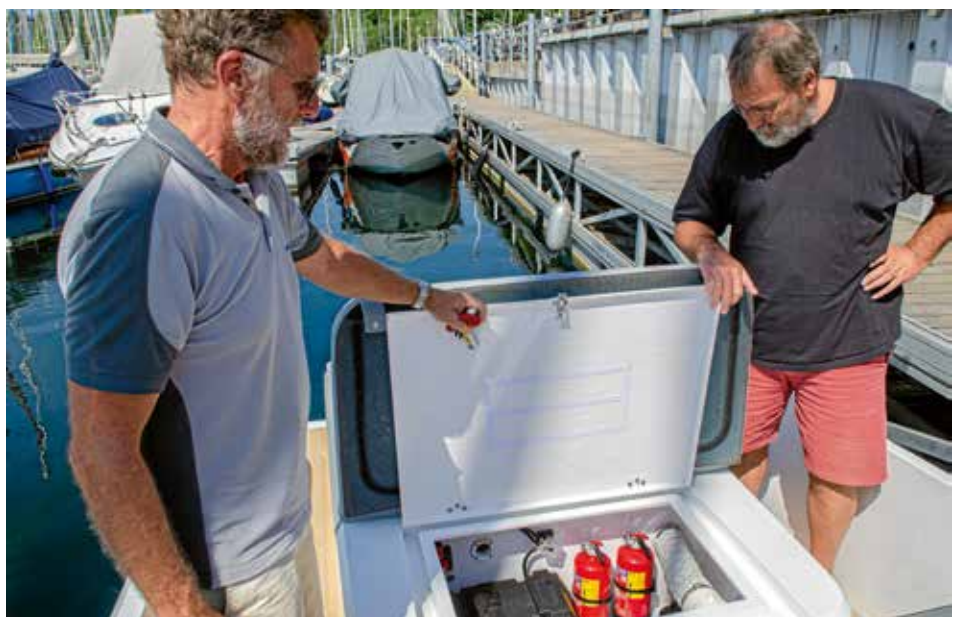
Tank, Elektrik, Gebläse und Feuerlöscher sind in einem abgeschlossenen Raum untergebracht.
