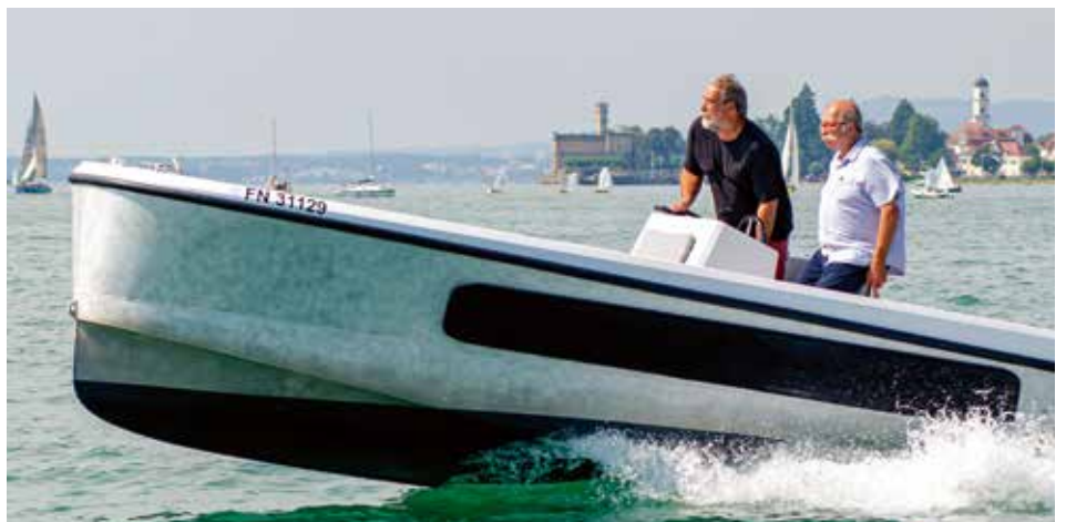
Tiefer V-Spant im vorderen Bereich und lange Wasserlinie für gute Rauwassereigenschaften.
