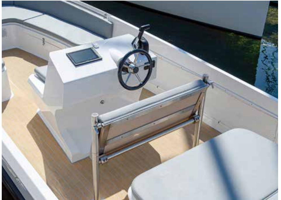
Die „Lehne“ für stehendes Fahren kann wahlweise auch als Sitzbank nach unten geklappt werden.
